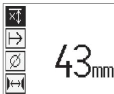
С помощью кнопок со стрелками выберите функцию ограниченной глубины сканирования и нажмите кнопку подтверждения.
