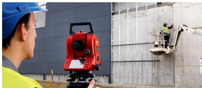
Aufmessen von Altbauten und Festlegung der Verankerungspunkte. Der Hilti Tachymeter führt Sie Schritt für Schritt durch vorprogrammierte Messaufgaben. Für das genaue und schnelle Einrichten der Profile bietet Hilti ein abgestimmtes Portfolio von Rotationslasern, zum Beispiel den Hilti PR 30-HVS.
