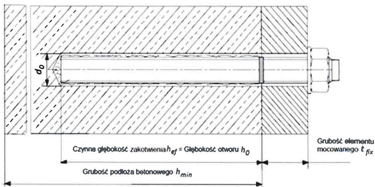
Rysunek Z-1. Schemat mocowania elementów kotwiących: HAS i HIT
