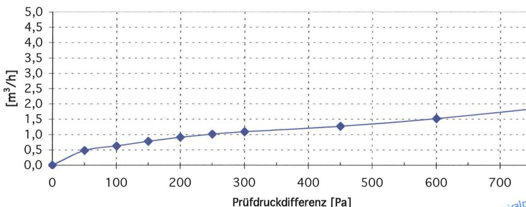
Diagramm 1: Grafische Darstellung der Prüfstandundichtigkeit (Längsfugen)
